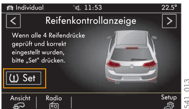
Virtuelle Set-Taste im Menü „Reifenkontrollanzeige“ des Infotainments (Beispiel)
